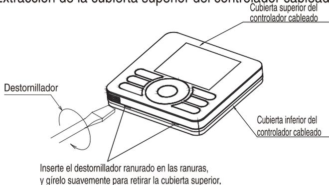
**Nota:** El tablero de control del controlador cableado se coloca en la cubierta superior. Por favor, protéjalo del rayado durante la extracción y la instalación.
