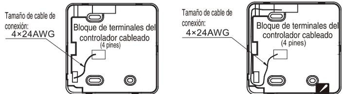
Conecte el bloque de terminales de controlador cableado con bloque de terminales interior mediante el cable de conexión. Para los detalles, consulte el diagrama de cableado interior.
